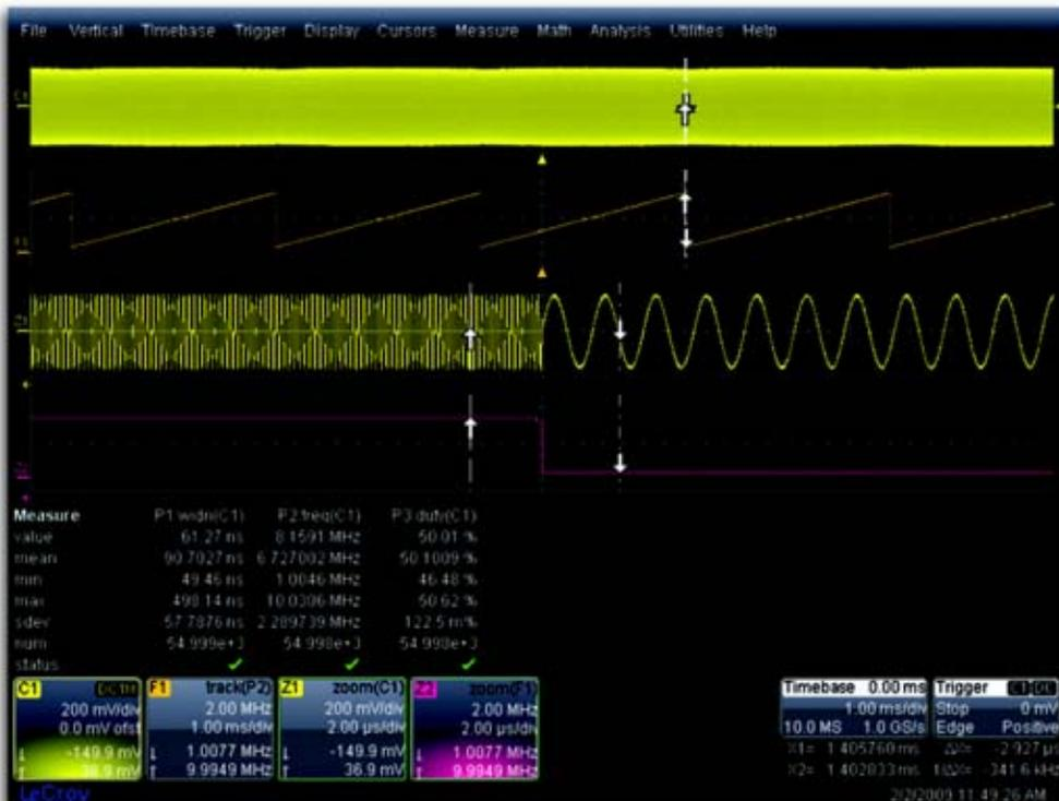
在启动过程中监测供电器件马达速度控制器的 PWM 信号。它使用 Width 参数。在采集过程中测量 Width 的所有实例。然后应用 Track，确定什么时候速度进入稳态(即什么时候器件旋转达到稳定状态)。
