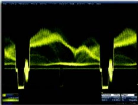
由于 WaveStream 模式中的采样速率可以高达 10 GS/s (是其它示波器的 5 倍), 因此它可以有效找到欠幅脉冲或毛刺。通常会以可视方式评估时间抖动, 了解大体行为。WaveStream 可以简便地了解边沿或眼图中的抖动。WaveStream 还可以把合成行为 (WaveStream) 与单一事件 (实时采样) 行为关联起来。可以在 WaveStream 模式下捕获数据, 切换到查看或缩放一条轨迹, 然后再切回到 WaveStream 模式。
