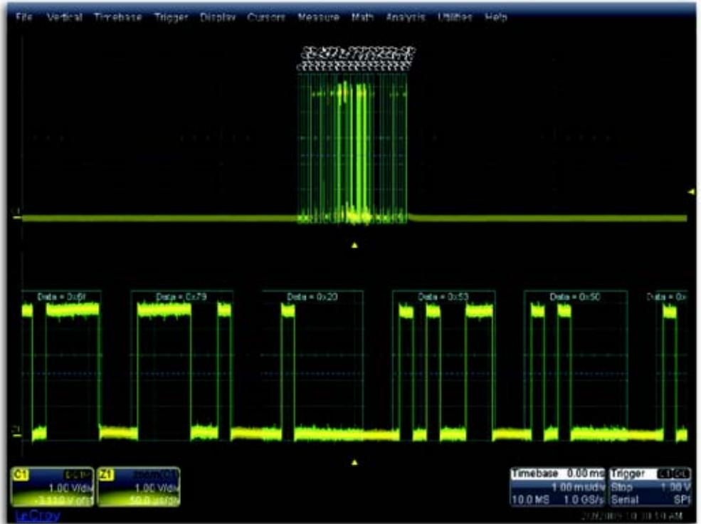
择要触发的数据值范围,而不只是一个数据值。I<sup>2</sup>C通常采用数据字节指定子地址,访问EEPROM中的存储位置。条件数据触发允许触发与EEPROM中特定子地址存储块读写对应的一个数据字节范围。它还可以协助监测来自基于 I<sup>2</sup>C 的传感器的数据输出,如模数转换器,并在数据位于安全工作范围之外时触发采集。在这两种情况下,都可以简单地检验操作是否正确。
