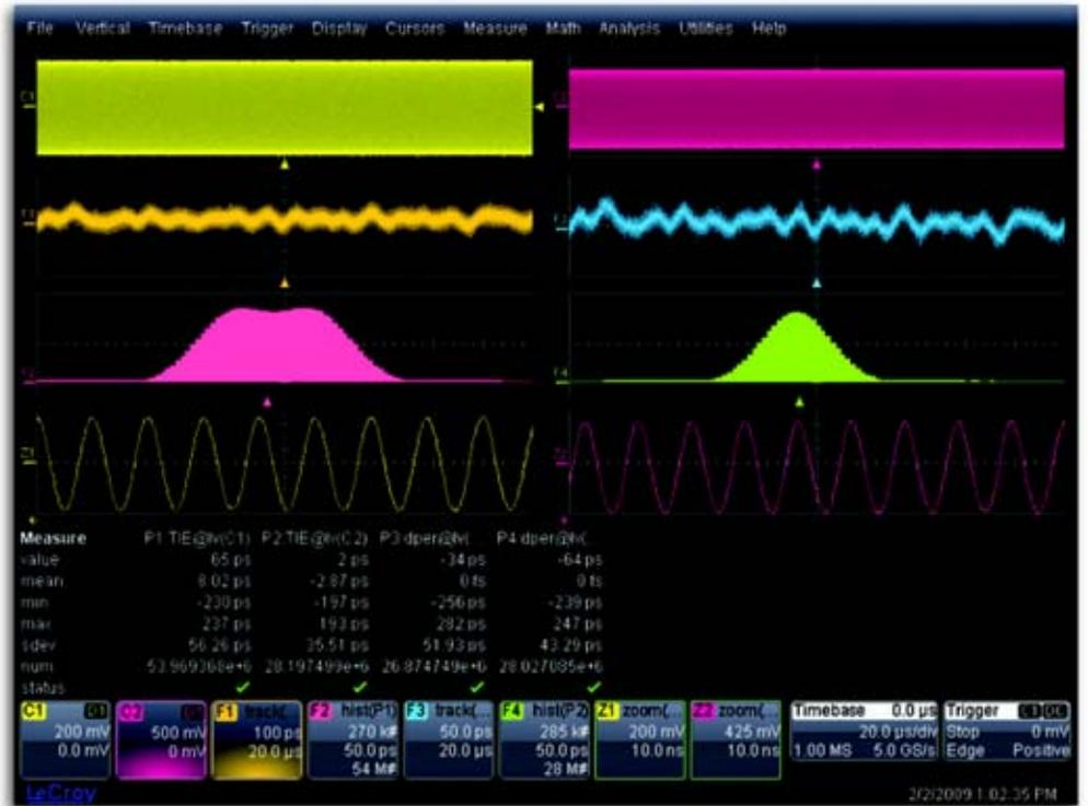
使用 20 Mpts 的采集数据(400,000 个周期)以 10 GS/s 的取样速率采集 200 MHz 时钟信号。使用追踪图和直方图测量周期间抖动和周期抖动。周期间抖动显示了不同的形态。现在可以采集信号，并实现时间相关，了解直方图形态。
